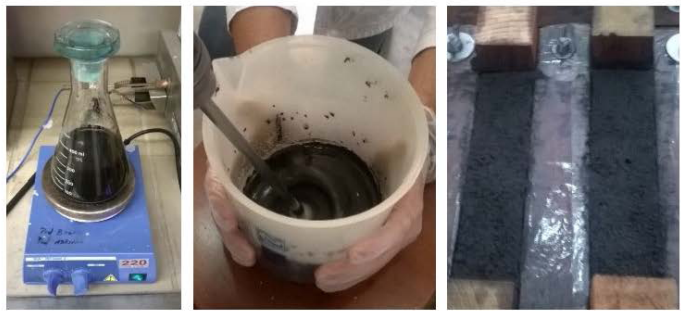
Figura 1. Da esquerda para a direita, etapas de dissolução da sílica contida na CCA, amassamento e moldagem
